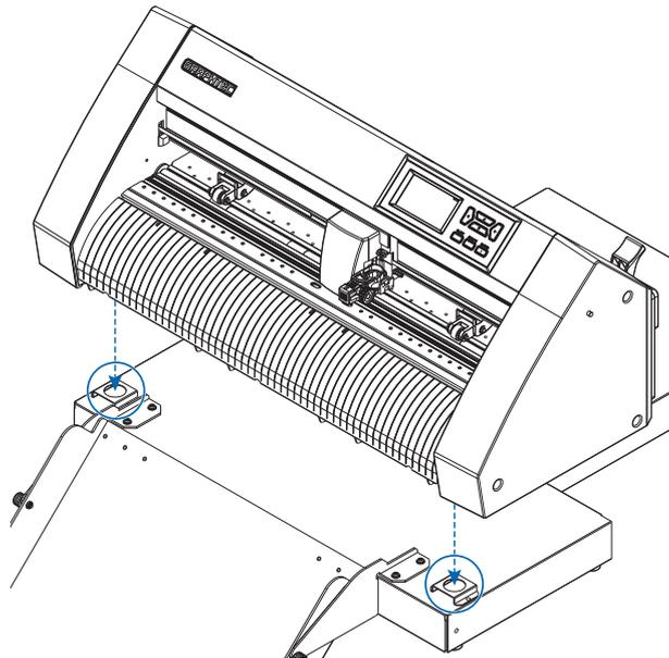
2. Après avoir installé le CE8000-40, appuyez sur le CE8000-40 dans le sens de la flèche sur la figure ci-dessous.
