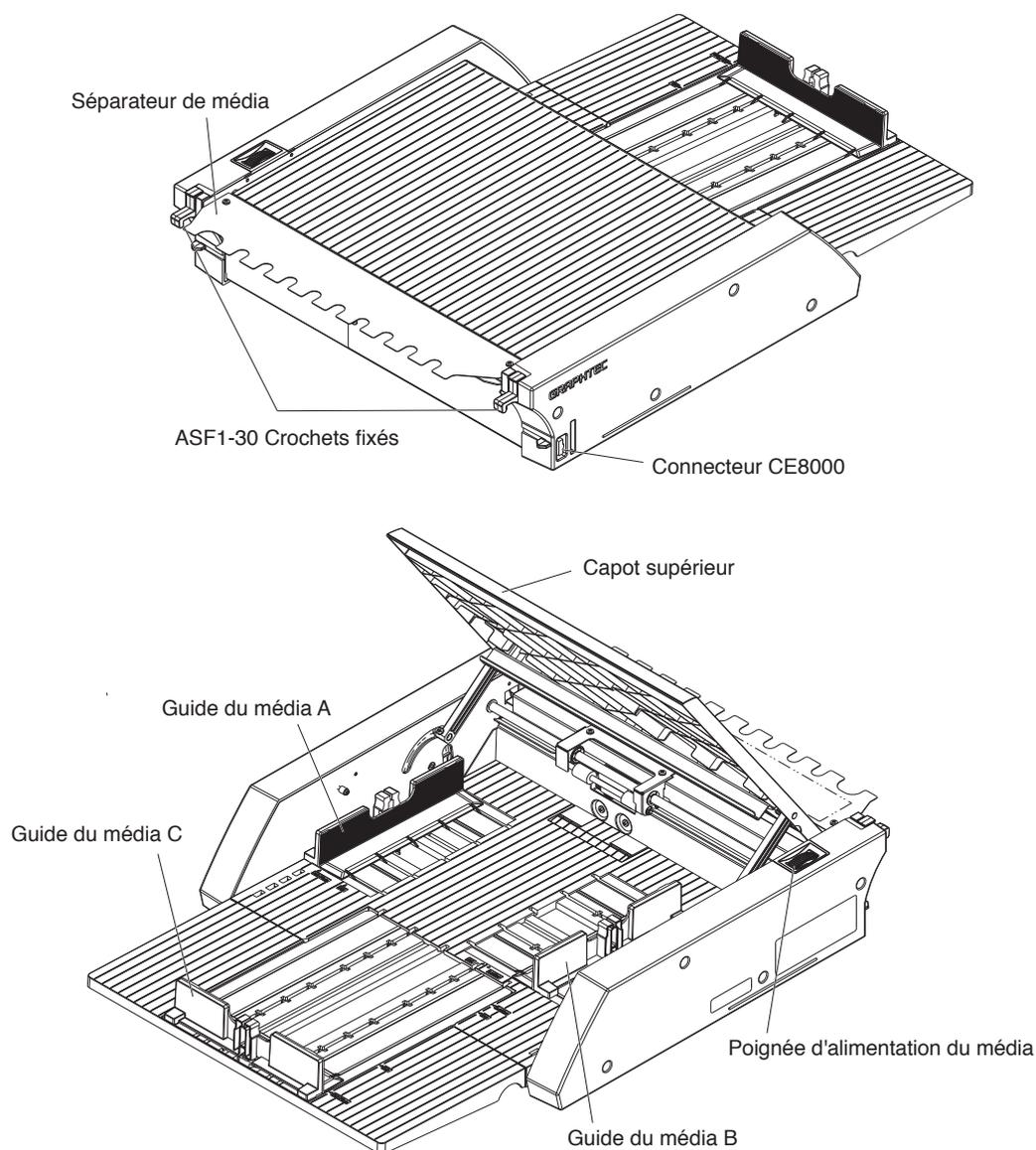
ASF1-30 Crochets de fixation.....Il s'agit d'un crochet pour fixer les modèles ASF1-30 et CE8000-40.
