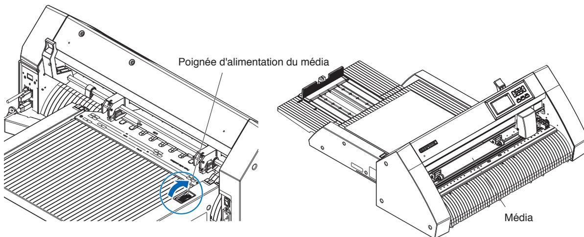
2. Réglez la position du galet de manière à ce que la distance entre le bord du média et le bord du galet soit de 5 mm.
