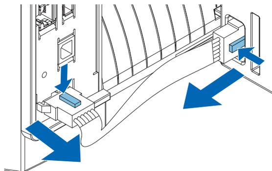
4. Soulevez le crochet de fixation de l'ASF1-30, puis retirez l'ASF1-30 vers l'arrière.
