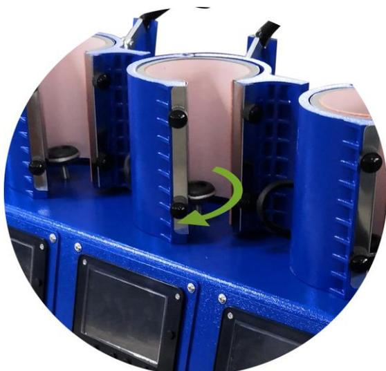
Tourner la vis de réglage de la pression dans le sens inverse des aiguilles d'une montre pour augmenter la hauteur
